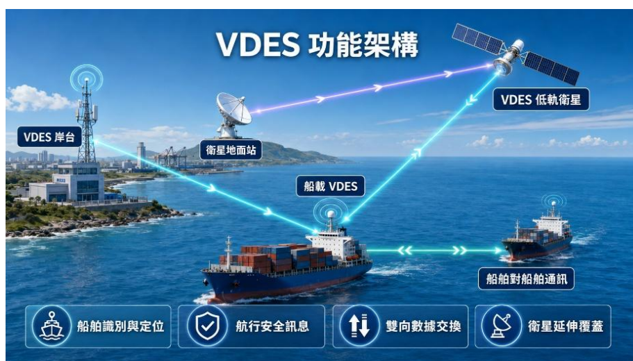
圖1：特高頻資料交換系統(VDES)功能架構
